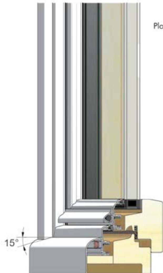
La jonction entre la tapée et la bavette est réalisée par une coupe à 15°.
