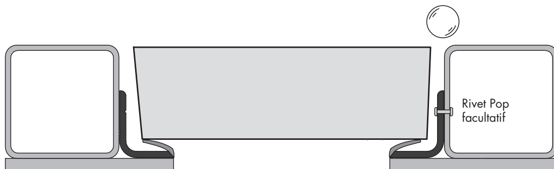
Mise en œuvre sur tube carré soudé
