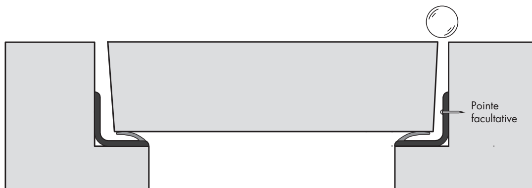
Mise en œuvre sur huisserie bois
