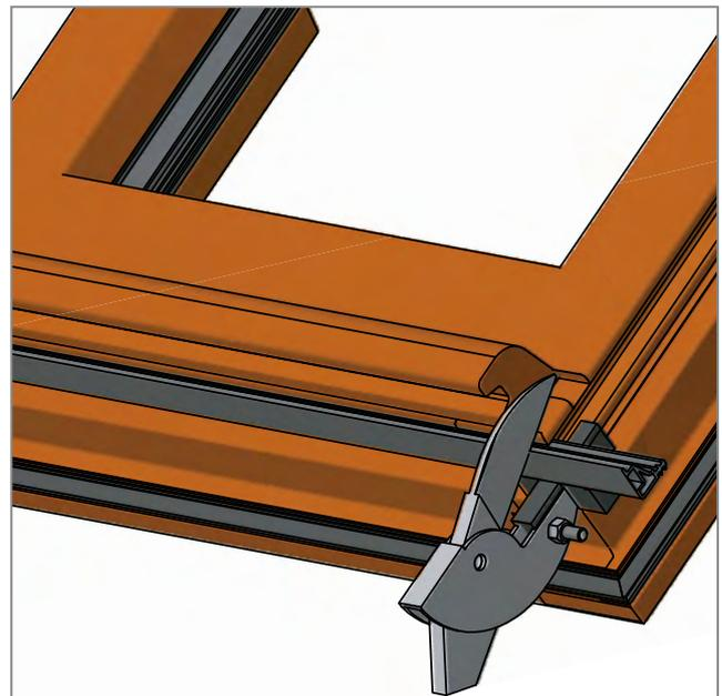
Grugeage de la queue de sapin : mettre le joint en butée sur le support de coupe.
