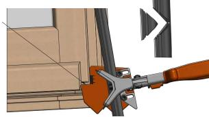
Réaliser une coupe d'extrémité. Puis positionner le joint en rainure.
