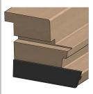
Déposer du mastic sous le pied de dormant et dans la rainure.
