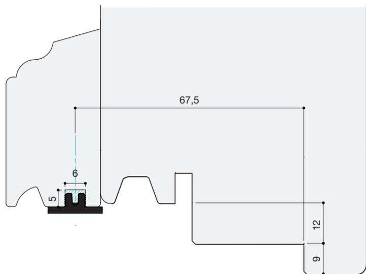
Queue de sapin magnétique à coller en rainure sur jet d'eau bois.
