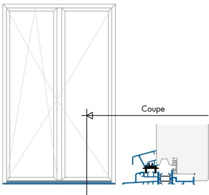
**LE SEUIL Hauteur 20 mm / Bois de 68 mm à rupture de PONT THERMIQUE + étanchéité MAGNÉTIQUE**
